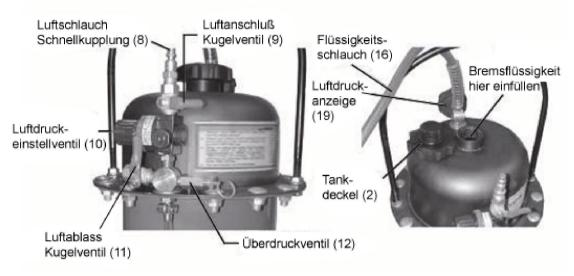
Bremsenentlüften und Bremsflüssigkeit nachfüllen
