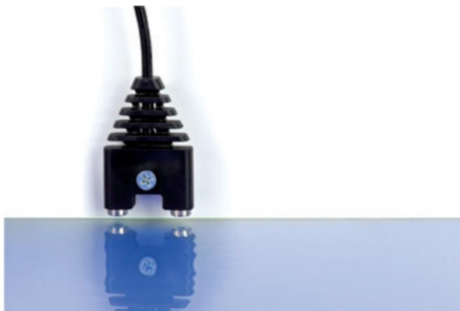
Der Wassersensor WS 10 eignet sich in Verbindung mit dem H-TRONIC Wasserpegelschalter WPS 1000 (Art.-Nr. 1 11 44 20) zur automatischen Pegelüberwachung von leitenden Flüssigkeiten in Behältern, Brunnen, Kellerräumen u.ä. Die Metallsensoren sind in ein Kunststoffgehäuse eingegossen. Dieser Messsensor mit 10 Meter langem PVC-Anschlusskabel ist nur zur Detektion von Flüssigkeiten in nicht aggressiven Medien bestimmt.
