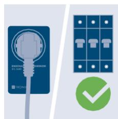
Una volta acceso l'apparecchio elettrico, il limitatore di corrente **SCL 3680** limita i picchi di carico tipici degli apparecchi più potenti, in modo da non far saltare il fusibile del circuito interessato.
