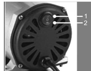
Interruptor 1: Interruptor de baja presión con parada automática para la aerografía
