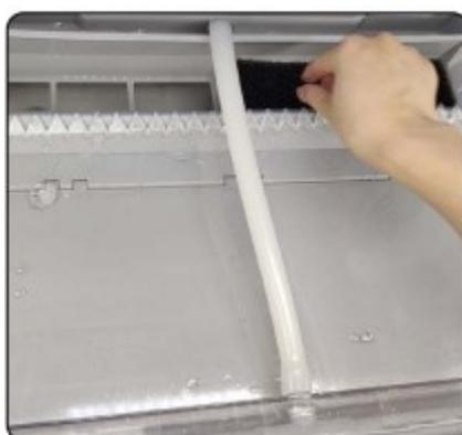
Le spugne filtranti vengono utilizzate ciclicamente e possono essere reinstallate dopo la pulizia.
