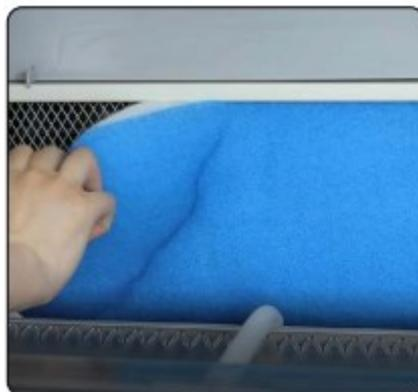
Rimuovere il filtro per sostituirlo con uno nuovo.
