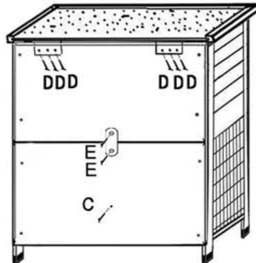
Fixer le bas de la rampe à travers le panneau arrière avec la vis **C**.
