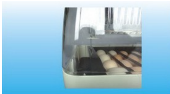
Fig. 4: Asegúrese de que la varilla para voltear los huevos se encuentre en la carcasa transparente situada en la parte superior del aparato. Esta varilla debe estar conectada a la balda giratoria a través del canal de conexión para que el mecanismo de giro se pueda realizar de forma automática y regular. Mientras la máquina esté enchufada a la corriente, el giro se produce de manera automática cada 4 horas.
