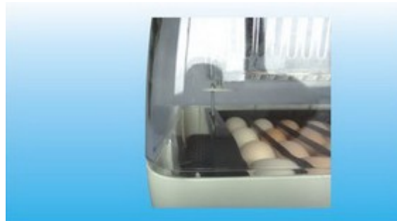
Image 4: Assurez que vous la tige qui sert à retourner les œufs se trouve en haut de l'appareil dans le boîtier transparent. Cette manivelle doit être reliée à travers le canal de connexion au tiroir réglable, de sorte que le processus de retournement peut se dérouler de manière automatique et régulière. Tant que l'appareil est alimenté, le tournement automatique a lieu tous les 4 heures.
