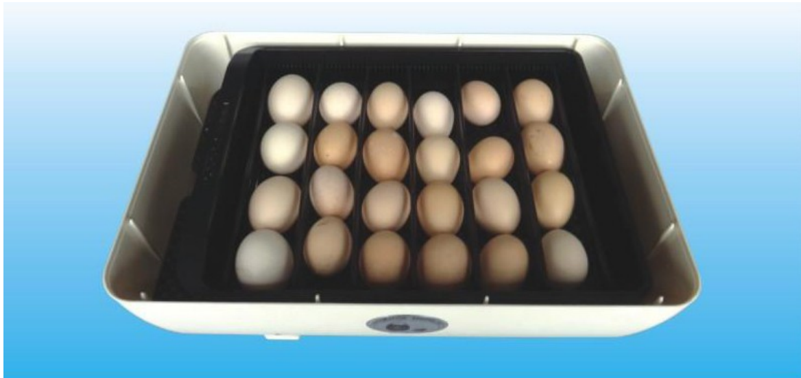
Image 3: Pour l'incubation, mettez le plateau avec les œufs comme indiqué ci-dessus, sur le plateau-grille (tamis). La distance entre chaque œuf doit être de 5-10mm plus grande que le diamètre de l'œuf lui-même. Ceci assure un retournement idéal des œufs.
