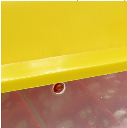
Fig. 3: Abertura para rellenado de agua
