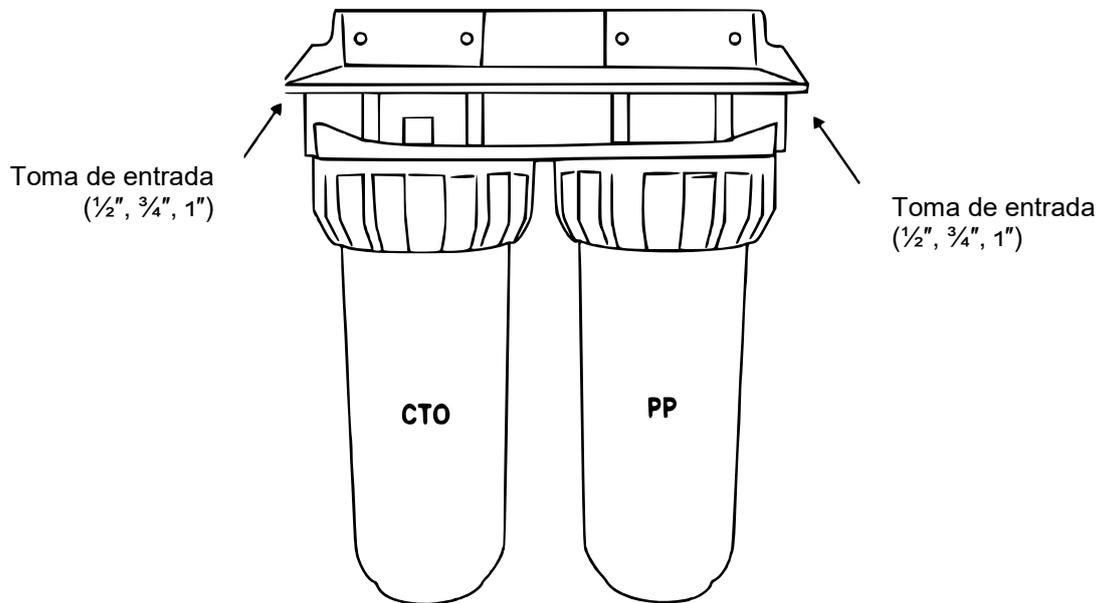
1. Este sistema de filtrado se envía con un **cartucho filtrante de sedimentos de 5 µ**, el cual elimina de forma fiable la arena, el óxido y las algas, así como otras partículas en suspensión del agua. La **segunda etapa de filtrado** consiste en un cartucho filtrante de carbón activado en bloque que limpia el agua potable de ozono, pesticidas, óxido, partículas de cal en suspensión, cloro, reduce la concentración de metales pesados como el plomo y el cobre.
