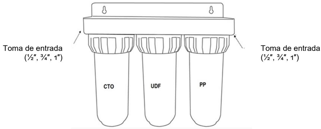
1. Este sistema para el filtrado de agua se envía con un cartucho **filtrante para sedimentos de 5 µ** que elimina de forma fiable la arena, el óxido, las algas y otras partículas en suspensión del agua.
