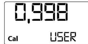
Nach dem Neustart verwendet das Messgerät den Kalibrierungs-Faktor, der gerade bestätigt wurde.
