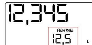
Die Durchflussmenge wird alle 0,7 Sekunden aktualisiert. Folglich ist die Anzeige bei niedrigen Strömungsgeschwindigkeiten relativ ungenau. Je höher die Strömungsgeschwindigkeit, desto genauer ist der angezeigte Wert.
