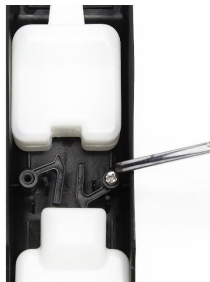
Um die Pumpe auf die Variante 2 umbauen zu können, müssen die beiden Schrauben gelöst und die Klammern gedreht werden. Dadurch können sich beide Schwimmer bewegen, und der Einschaltpunkt sinkt.
