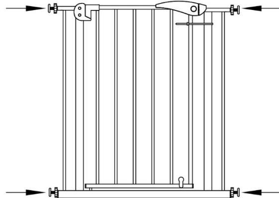
Schritt 2: Den Drehknopf eindrehen und sicherstellen, dass der Abstand zur Wand angemessen ist. Dann die Klemmbefestigungen mit der Gummipolster festdrehen. Je fester Sie drehen desto stabiler wird das Schutzgitter.
