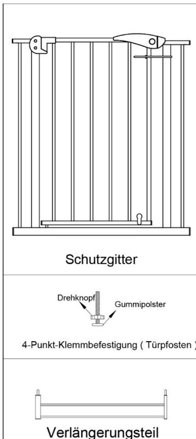
Sicherheitshinweise: Schneiden Sie nicht die Nylon-Kabelbinder, bevor die Montage beendet ist. Montageanleitung ohne Verlängerungsteil. Schritt 1: 4-Punkt-Klemmbefestigung ( Türpfosten ) einlegen
