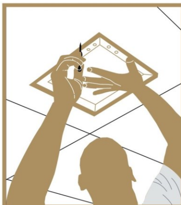
Passaggio 2 Dove sarà attaccato il sportello, tracciare il bordo interno.
