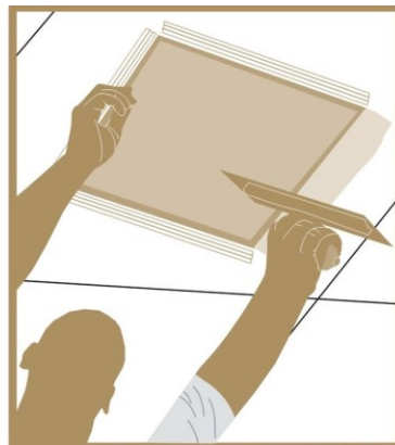
Passaggio 6 Infine, applicare nastro per cartongesso e mastice per cartongesso e reinstallare la porta dello sportello di ispezione.
