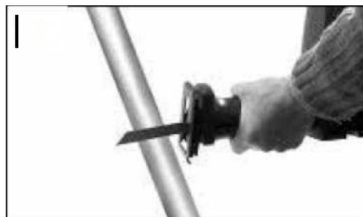
Non usare la forza per segare le lamiere sottili. Troppa forza accorcia la durata della lama e può causarne la rottura.
