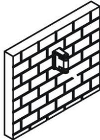
1. Markieren Sie mithilfe der Halterung die vier Positionen der Löcher an der Wand.
