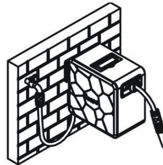
4. Befestigen Sie den Hahnanschluss am Hahn und verbinden Sie den Einlassschlauch mit dem Hahnanschluss.
