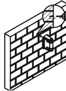
2. Bohren Sie Löcher an den markierten Stellen und befestigen Sie die Wandhalterung mit den mitgelieferten Schrauben an der Wand.
