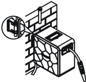
3. Verbinden Sie die Schlauchtrommel und die Halterung mit dem Anschlussrohr.
