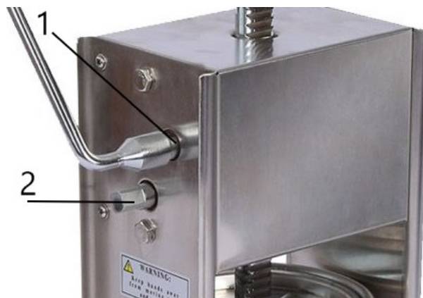
(1) arbre de l'entraînement rapide ; (2) arbre de l'entraînement lent
