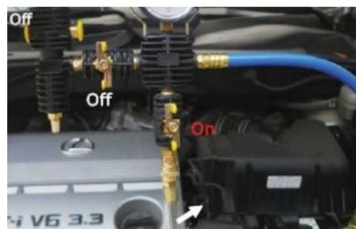
Figure 9 | flèche = point de connexion du tuyau de liquide de refroidissement
