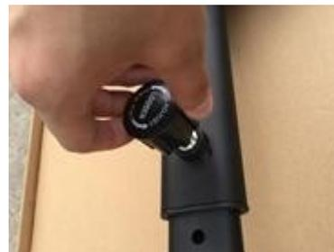
5. Ajustez le support du siège scooter à la taille de votre board et fixez le réglage avec les vis. Utilisez la clé à fourche **(5)** pour cela. Fixez maintenant le board avec les sangles en tissu avec Velcro fournies. Assurez-vous que le siège du scooter est solidement maintenu. N'utilisez le siège avec votre board que s'il peut être monté correctement.
