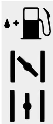
(a) Attacco per il rifornimento "MIX GASOLINE"
