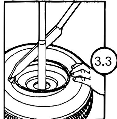
Lassen Sie die ganze Luft aus dem Reifen ab und platzieren Sie das Rad auf der Fixierstange an der Basis des Hauptständers. Setzen Sie den Wulstschuttschuh im Wulstbereich an und stellen Sie die Schwenkstange am Hauptständerfuß auf die richtige Höhe ein.
