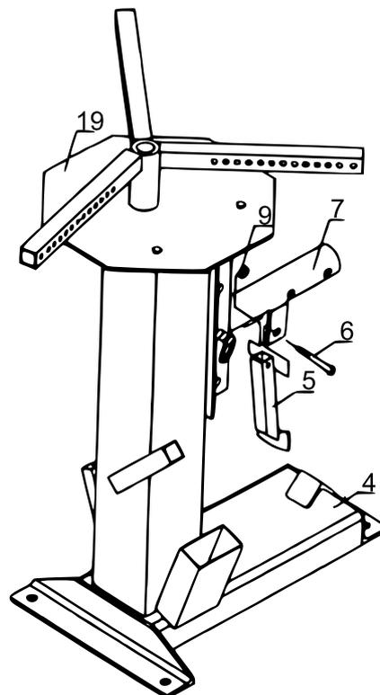
4. Befestigen Sie den Griff (10) an der Griffhalterung (7), indem Sie eine Schraube (24) und eine Kontermutter (12) verwenden. Ziehen Sie alle Schrauben und Muttern fest an.
