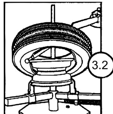
Der Reifen wird über das flache Ende des Reifenwerkzeugs hinweg montiert. Setzen Sie das Kugelkopfstück unter Druck auf der Reifenunterseite (immer zum Fahrer hin) zwischen Felge und Wulst an. Drehen Sie das Werkzeug mit der flachen Seite gegen die Mittelstange einmal ganz am unteren und oberen Rand des Schlauchs herum.
