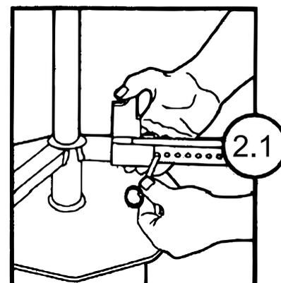
Die Gleitbackenklemme muss auf eine Position eingestellt werden, die größer als der Reifen ist, damit der Kurbelarm bedient werden kann.
