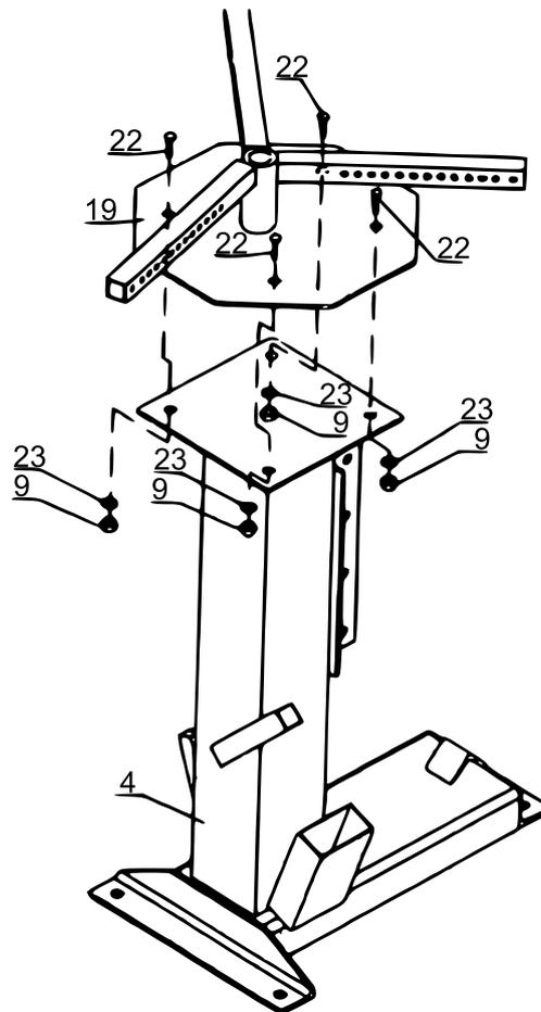
1. Befestigen Sie den Backenrahmen (19) mit Hilfe von Schrauben (22), Kontermuttern (9) und Unterscheiben (23) am Hauptständerfuß (4).
