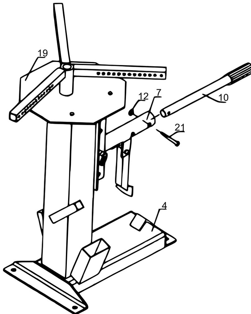
5. Stellen Sie den Hauptständer an der gewünschten Stelle auf den Boden. Lassen Sie einen Arbeitsbereich von mindestens 914 mm auf allen Seiten. Markieren Sie durch die Basislöcher die Stellen für die Bohrlöcher auf dem Boden und bohren Sie vier Löchern mit 12,7 mm Durchmesser.
