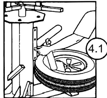
Setzen Sie die Demontagegestange in den Schuh ein und ziehen Sie sie nach unten, um die Wulst nach unten zu drücken. Bei Bedarf Reifen um 90° drehen und den Vorgang wiederholen. Um die Wulst auf der anderen Seite nach unten zu drücken, drehen Sie das Rad um und wiederholen Sie diesen Schritt.
