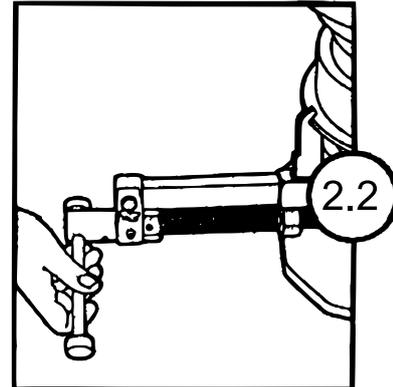
Das Rad wird in Position gebracht. Die Radfelge wird gegen die beiden Lochbackenklemmen gedrückt. Setzen Sie die entsprechende Mittelstange in die Radmitte und in das Mittelloch des Reifenwechslers ein. Ziehen Sie die Klammern an, um das Rad zu sichern.
