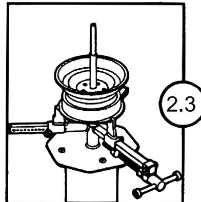
Entfernen Sie den luftlosen Reifen mit Hilfe des Endes der Reifenwerkzeugstange. Das Kugelende wird unter die obere Wulst geschoben und auf der Felge aufgelegt (s. Abb.). Während der Hebel mit einer Hand Richtung Mitte gedrückt wird, wird der Reifen mit der anderen angehoben und die Einheit kreisförmig gedreht.
