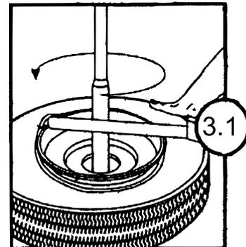
Heben Sie die untere Wulst auf die gleiche Weise ab wie oben. Der Winkel des Werkzeugs zur Mittelstange kann je nach Größe des Benutzers oder Tiefe der Felge angepasst werden; dadurch wird die Einfachheit der Bedienung nicht beeinträchtigt.
