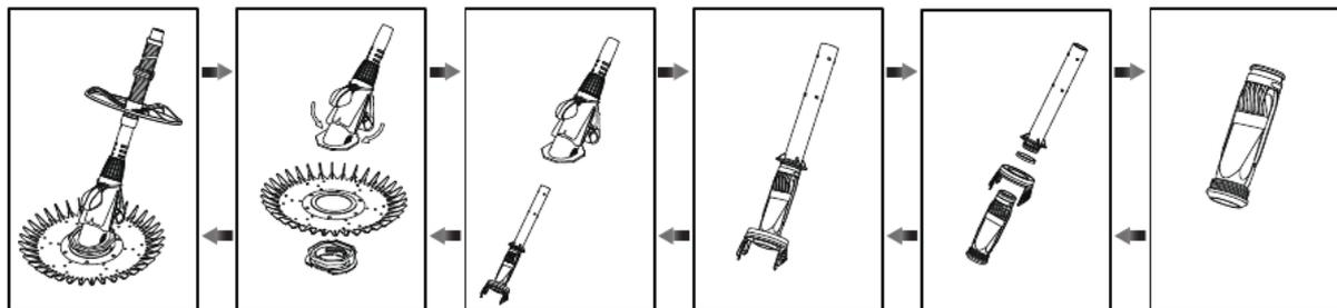
**Note !** Lors de la fixation de la pièce 2, la pièce 1 n'a pas besoin d'être retirée de la pièce 3. Enclenchez simplement la pièce 2 sur la pièce 1.
