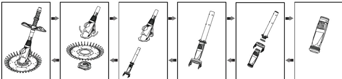
**Nota!** Quando si allega il componente 2, il componente 1 non deve essere rimossa del componente 3. Basta agganciare il componente 2 al componente 1.
