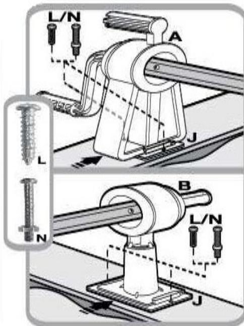
1. Posizionare i supporti dei rulli **A** e **B** con la piastra di base **J** sulle bordature esterne. Per i listelli di legno o di plastica, fissare una delle due piastre di base **J** direttamente al listello con la vite autofilettante **L**. A tal scopo utilizzare la vite e il dado **N**. Dopo la misurazione, il tubo deve essere prima montato nel portarullo. L'altro lato deve essere fissato di conseguenza dopo aver collegato il tubo.
