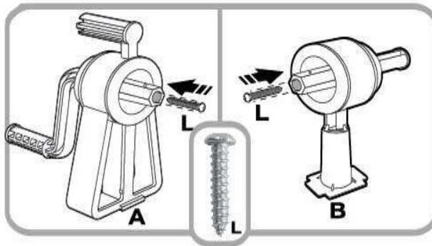
Inserire la vite **L** in **A** e **B**, poi stringerle saldamente.
