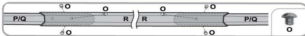
Per fissare il collegamento del tubo **R** con **P/Q**, serrare le tre viti **O** nei fori del tubo **R**, come mostrato in figura. È necessaria una sovrapposizione minima di 20 cm.
