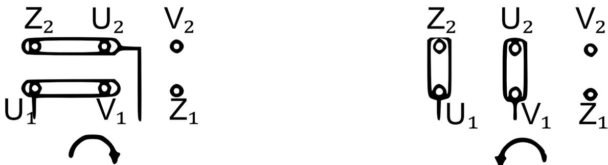
**Note** : le sens de rotation spécifié du point doit être vu de l'extrémité de l'arbre.
