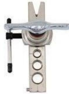
6. Pour retirer le tube, tournez le bouton vers le haut dans le sens inverse des aiguilles d'une montre. Ne desserrez le manche en T que lorsque le bouton a été tourné tout vers le haut. Retirez le tube.
