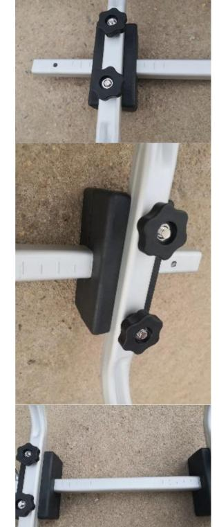
5. Ajuste los bloques de sujeción en el casquillo del eje. Las escalas en el casquillo pueden ayudar a hacerlo. Cuando se haya encontrado la posición óptima, apriete los tornillos de los dos bloques de sujeción.
