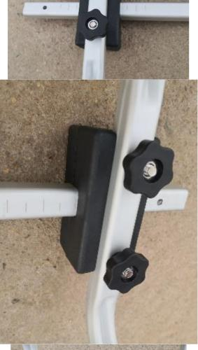
5. Arranger les blocs de serrage sur la douille d'axe. Les marquages vous aideront. Resserrer les boutons des deux blocs de serrage.
