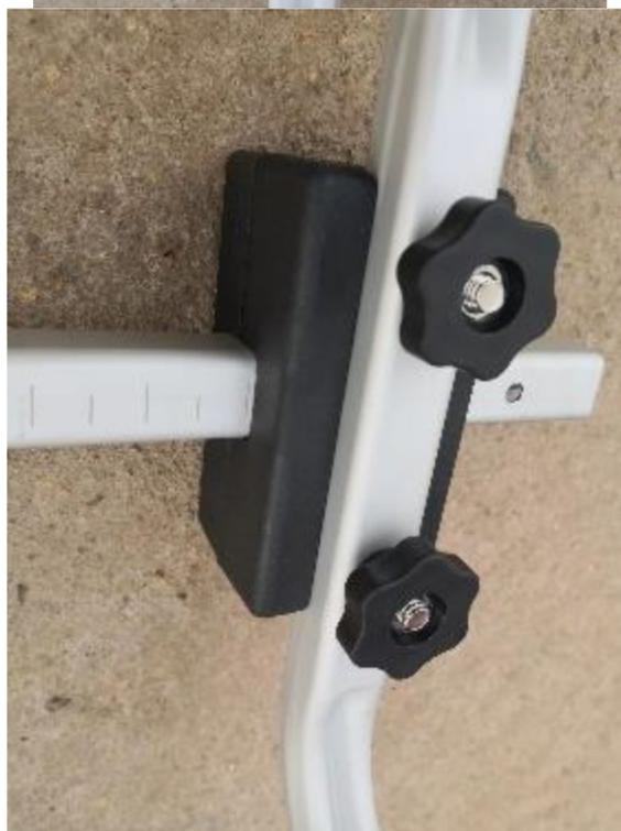
5. Regolare i dispositivi di bloccaggio sul tubolare quadrato dell'asse. I segni sul tubolare fungono da orientamento. Serrare le manopole di blocco su entrambi i lati.
