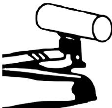
Coloque siempre la carga en el centro de la superficie de apoyo del gato para que descansa lo más segura posible.
