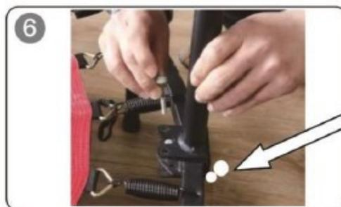
7. Fissare le barre di supporto laterali con l'aiuto delle viti.
