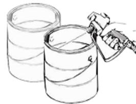
4. Siga apretando el gatillo. En cuanto la solución de limpieza salga de la pistola pulverizadora, apunte con la pistola a la parte lateral interior del cubo de residuos. **Conecte siempre la pistola a tierra sujetándola contra un cubo de metal cuando enjuague el aparato con disolventes inflamables.**
