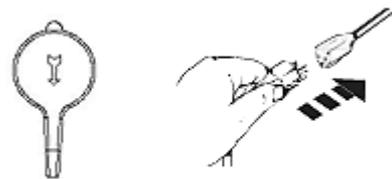
3. Gire el botón **PRIME/SPRAY** a **SPRAY** Pruebe el funcionamiento del pulverizador sobre una pieza para practicar y empiece a pulverizar.
