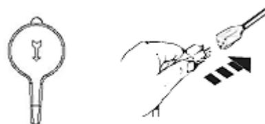
3. Girare la manopola **PRIME/SPRAY** su **SPRAY**. Provare lo spruzzatore su un pezzo di prova e iniziare a spruzzare.
