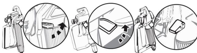
2. Ruotare la manopola **PRIME/SPRAY** su **PRIME**. Spegner la pompa posizionando l'interruttore su **OFF (O)**. Scollegare la spina dello spruzzatore.
