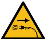
Wenn Sie Wartungsarbeiten an der Maschine durchführen oder wenn das Stromkabel eingeklemmt oder beschädigt ist, schalten Sie immer den Motor aus und ziehen Sie den Netzstecker.
