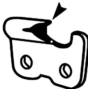
Mantenere tutte le maglie della catena alla stessa altezza. Iniziare con il collegamento più danneggiato e limare tutti i collegamenti in modo uniforme.
