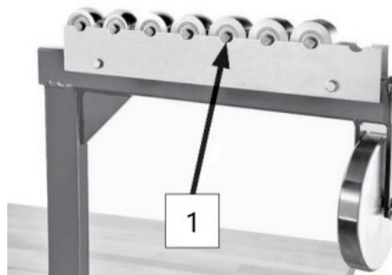
Fig. 10 – Montaje de los rodillos inferiores en el soporte
