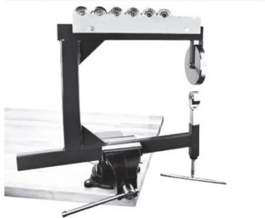
Fig. 3 – Ejemplo de montaje en una mordaza sobre un banco de trabajo
