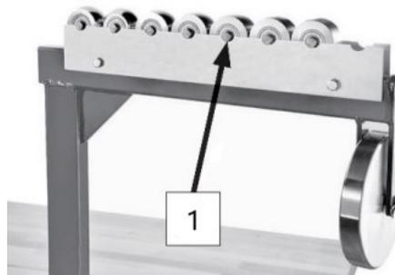
Fig. 10 - Montaggio delle ruote inferiori sul portaruota
