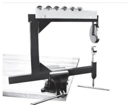
*Fig. 3 - Esempio di fissaggio in morsa su un banco di lavoro*
