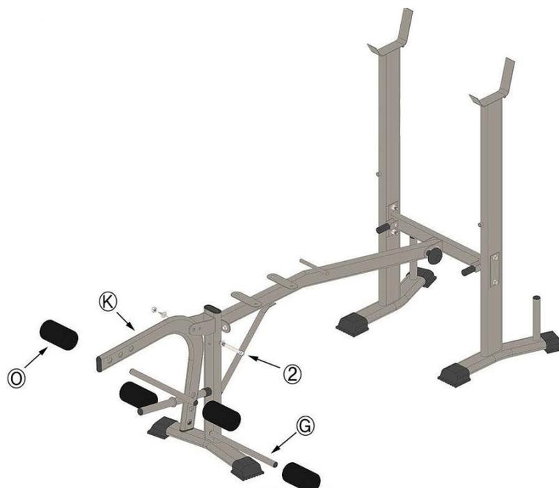
Avec des écrous (2), attachez la barre d'entraînement frontale courbe (K) sur le support frontal. Faites glisser le petit levier (avec mousse) (G) à travers le trou (voir fig.), puis couvrez chaque extrémité du petit levier (G) avec un petit capuchon en mousse (O).
