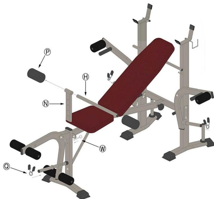
Insérez la longue barre (avec mousse) (**H**) dans le levier d'ajustage (**N**). Puis faites glisser un grand capuchon en mousse (**P**) sur chaque extrémité de la longue barre. Insérez le module complet (**H**, **N**, **O**) dans le support frontal et fixez-le en utilisant la goupille annelée (**W**). Pour terminer l'assemblage, attachez les clips à ressort (**Q**) comme illustré.
