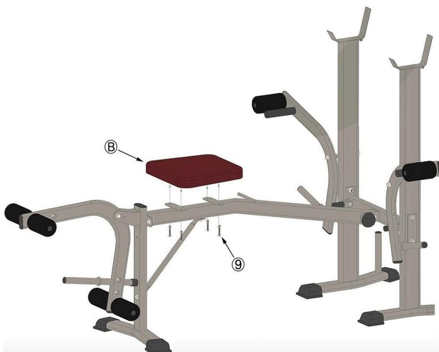
Placez le siège (B) sur la barre principale et attachez-le en utilisant des écrous (9).
