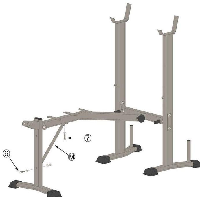
Avec des écrous (6) et des écrous (7), connectez la barre principale et le support frontal avec la barre de renfort (M).
