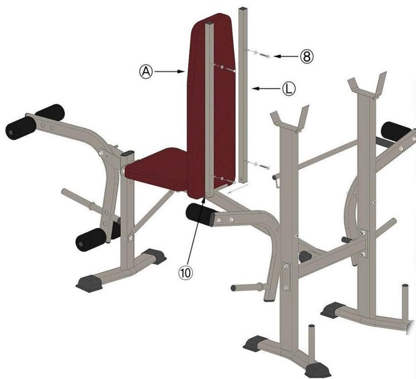
En utilisant des écrous (10), attachez les barres de support de dossier (L) sur la barre principale, fixez le dossier (A) sur les barres de support de dossier et vissez-le en utilisant des écrous (8).
