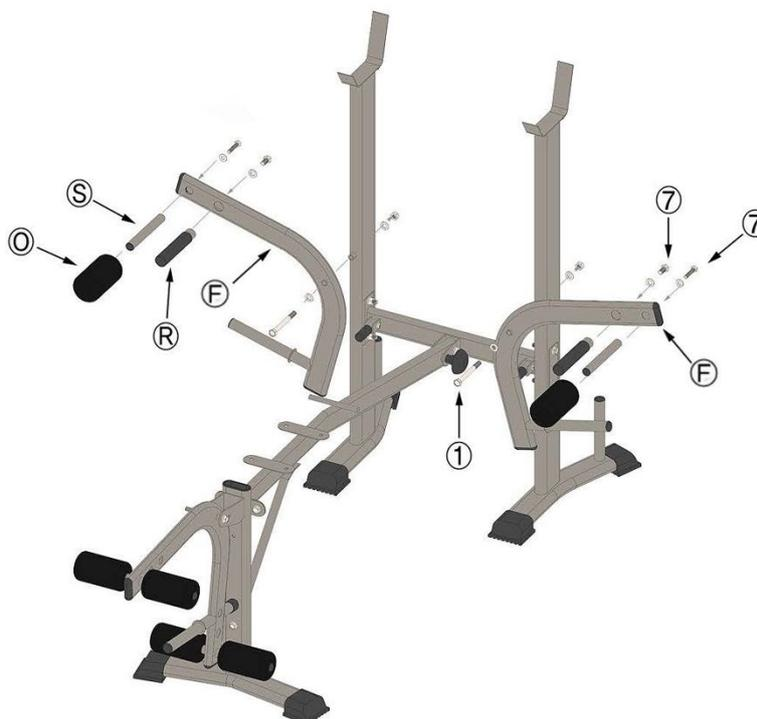
Avec des écrous (1), attachez les barres d'entraînement latérales courbes (F) sur les barres de support d'haltères. Faites attention à ce que les barres F soient correctement orientées (voir fig.). Insérez les poignées (R) et les leviers de retenue (S) dans les trous larges des barres d'entraînement latérales courbes et fixez-les en utilisant des écrous (7). Couvrez les deux leviers de retenue (S) avec un petit capuchon en mousse (O).
