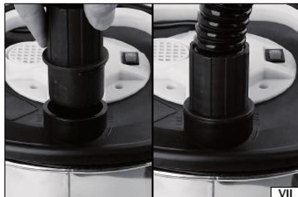
Um den Schlauch später abzunehmen, drehen Sie den Anschluss in die Richtung des Pfeils mit der Aufschrift „LOOSE“ und ziehen Sie ihn aus dem Einlass heraus.
