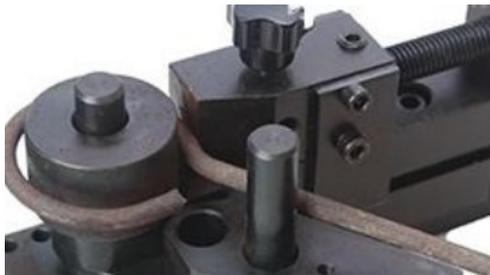
1. Inserite una matrice di curvatura circolare della dimensione appropriata.
