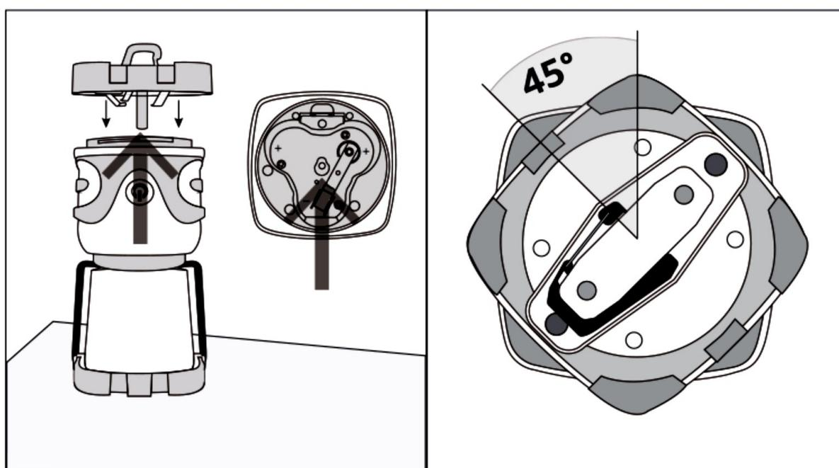
3. Replacer le socle tout en veillant à ce que la goupille soit dans la bonne position (flèche). 4. Reverrouiller le socle en le tournant.
