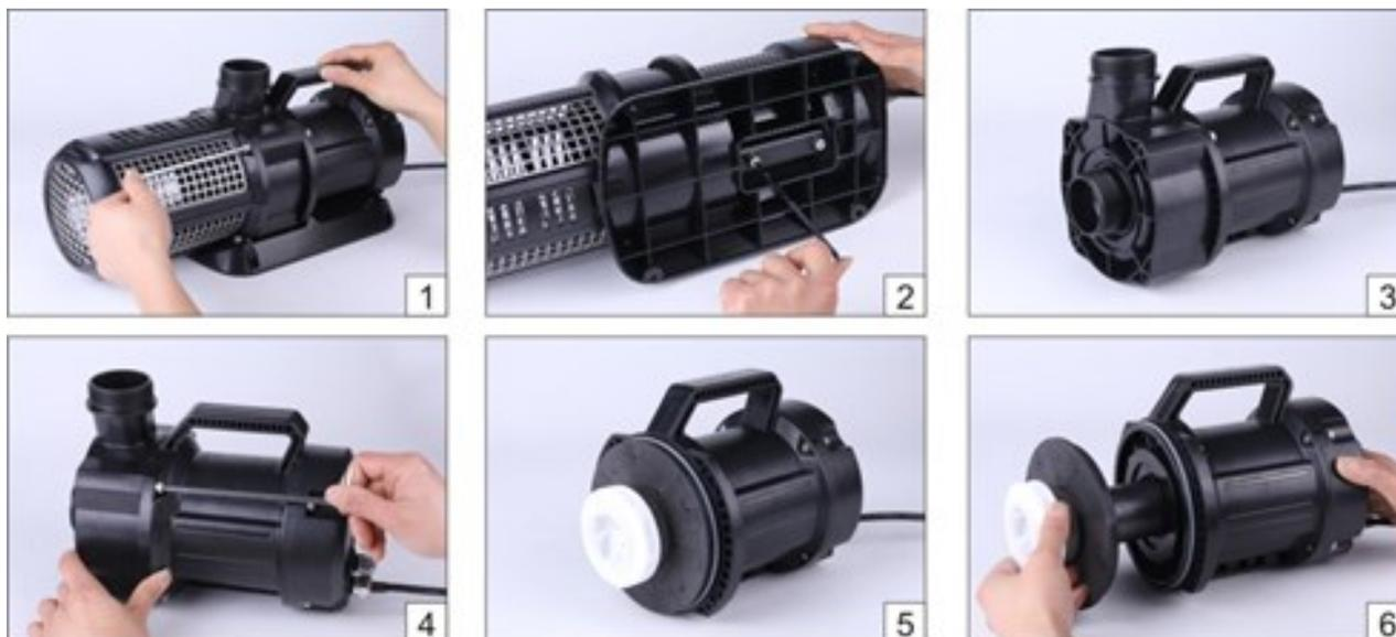
1. Utilice un destornillador hexagonal para aflojar los 4 tornillos de la cesta del filtro (vea fig. 1) y los 2 tornillos de la placa base (vea fig. 2) y retire la cesta del filtro y la placa base. La figura 3 muestra el aparato terminado.
