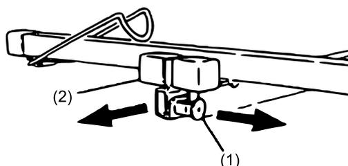
**Importante:** No cargue el elevador ni modifique la altura sin los pasadores de seguridad encajados o los soportes extendidos a más de 80 cm. Antes de transportar o almacenar el dispositivo los brazos de extensión tienen que estar completamente recogidos para evitar daños.
