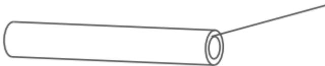
Die Leitung wird mit einem Rohrschneider flach und glatt ohne Grat abgeschnitten.
