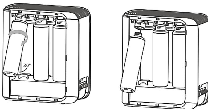
3. Insérez la nouvelle cartouche en la tournant dans le sens des aiguilles d'une montre comme indiqué, puis fixez le support latéral.
