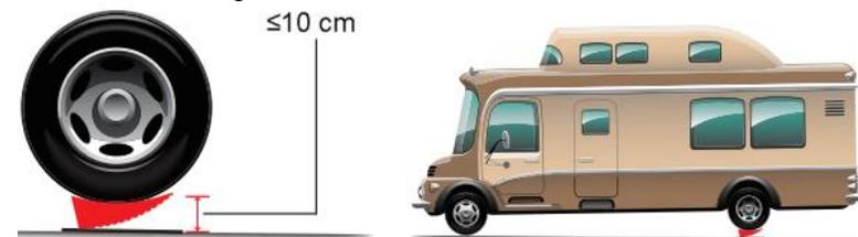
4. Klemmen Sie den Unterlegkeil unter dem Hauptkeil fest. Dies verhindert, dass das Fahrzeug sich bewegt, und sichert dessen Position während einer Wartung oder einer Pause.
