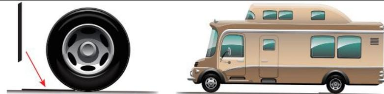
2. Klemmen Sie das dünne Ende des großen Keils zwischen Reifen und Gummimatte fest. Dies sorgt für eine sichere Positionierung und verhindert ein Verrutschen während des Vorgangs.
