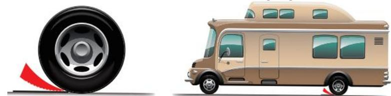
3. Stellen Sie sicher, dass die Lenkung des Fahrzeugs parallel steht. Fahren Sie langsam auf, bis das Fahrzeug waagrecht steht. Dies minimiert das Risiko eines Abrutschens und stellt sicher, dass das Fahrzeug stabil steht.
