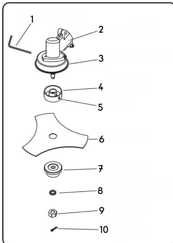
**! WARNUNG! VORSICHT! ÜBERMÄßIGE SCHWINGUNGEN – MOTOR SOFORT ABSTELLEN!** – Übermäßige Schwingungen der Klinge zeigen an, dass diese nicht richtig installiert ist. Stellen Sie den Motor sofort ab und überprüfen Sie die Klinge. Eine unsachgemäß installierte Klinge kann zu Verletzungen führen. Verwenden Sie bei der Wartung des Geräts nur Originalteile.
