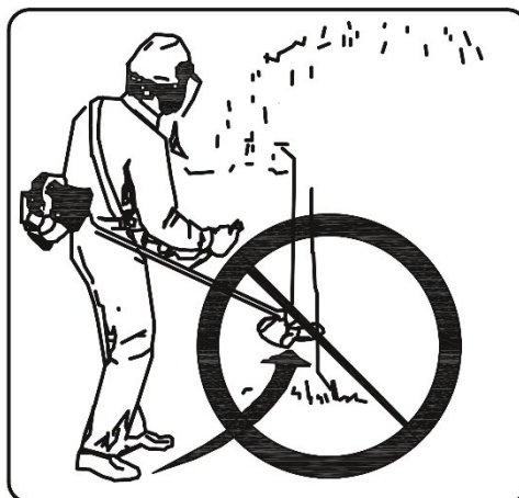
NON TAGLIARE ATTRAVERSO I TRONCHI PIÙ SPESII!
