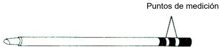
Para comprobar si el conector del soldador está dañado, debe medirse la resistencia entre el tercer polo del conector y la punta de soldadura. El valor no debe superar los 2  $\Omega$ . Si esto sigue siendo el caso después de limpiar la punta de soldadura, el enchufe del conector es defectuoso y debe ser reemplazado.
